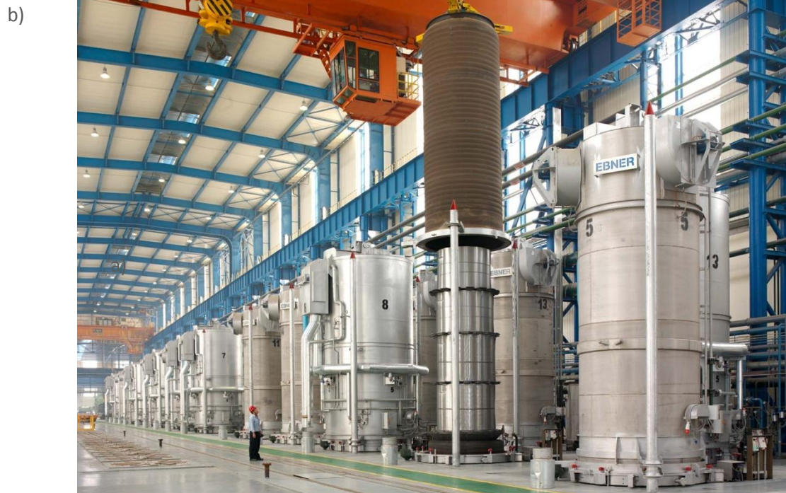
Slika 6: Zvonaste peći: a) šematski prikaz, b) slika pogona za termičku obradu limova u kome se nalaze zvonaste peći preduzeća Ebner.
